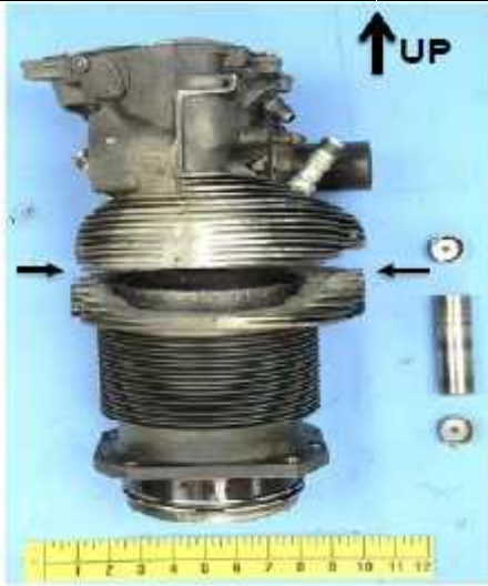
Figura 1. Cilindro número 1 tal como se recibió, que contenía una fractura circunferencial en la zona entre las flechas sin marcar; pistón que fue enviado parcialmente insertado en el orificio del cilindro; y el pasador del pistón desmontado y las tapas de los extremos del
