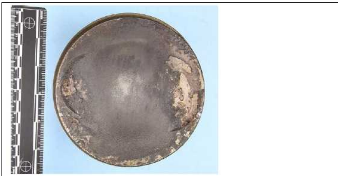
Figura 5. Fotografía de la superficie superior del pistón que muestra depósitos de combustión.
