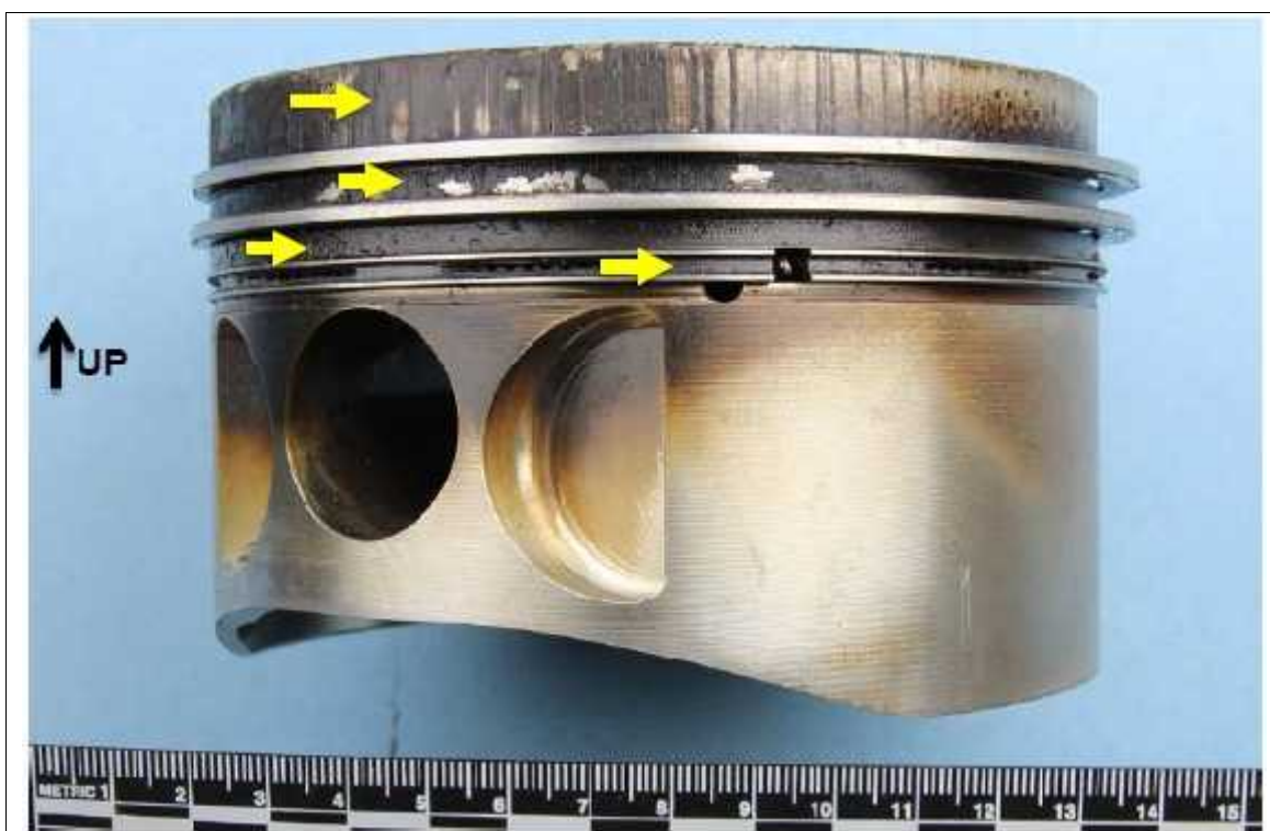
Figura 6. Fotografía de la vista lateral del pistón que muestra depósitos de combustión negros alrededor de la circunferencia del pistón, en las zonas indicadas por las flechas amarillas.
