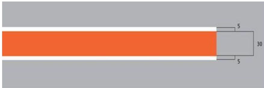
Figura 2-4-1. Línea de seguridad en plataforma ABL
