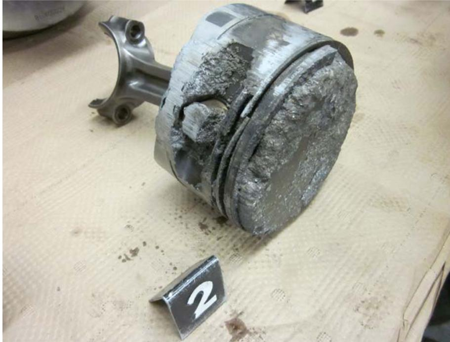
Aquí está el pistón. La plataforma del pistón está erosionada. Los anillos están rotos. La falda del pistón está desgastada por el roce con la pared del cilindro. La razón por la que esto es importante es que un pistón en esta condición permite que los gases de combustión ingresen al cárter. Esto presuriza en exceso al cárter y expulsa el aceite del motor por el respiradero del cárter... todo el aceite del motor... en minutos.
