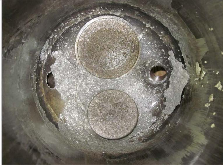
Esta es una culata que muestra signos de pre-encendido o detonación. El revestimiento de carbono que normalmente recubre el domo de la cabeza se elimina. Hay material del pistón derretido en la cabeza y la camisa del cilindro está rayada por el pistón sobrecalentado
