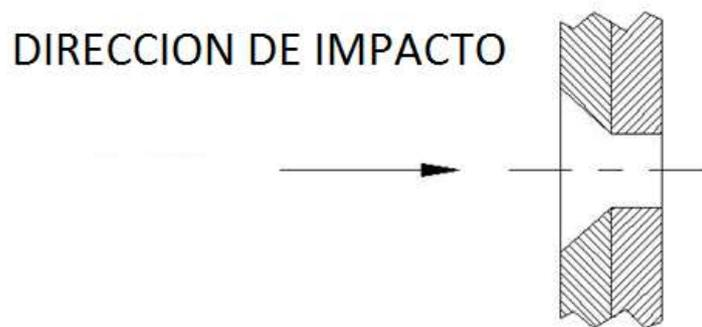
**Figura ADJB-7. Ejemplos de sujetadores Frangibles**
