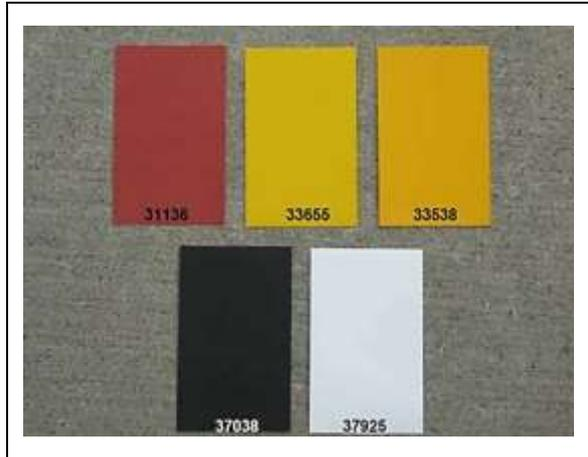
Figura C-19 Norma Federal de Colores 595B para señales del campo de vuelo.
