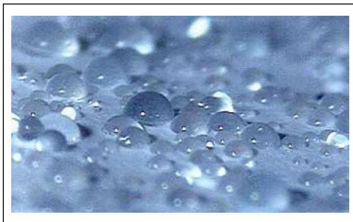
Figura C-18 Embebido óptimo de las microesferas de vidrio
