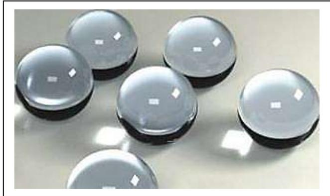
Figura C-3. Señales que contienen pintura con microesferas
