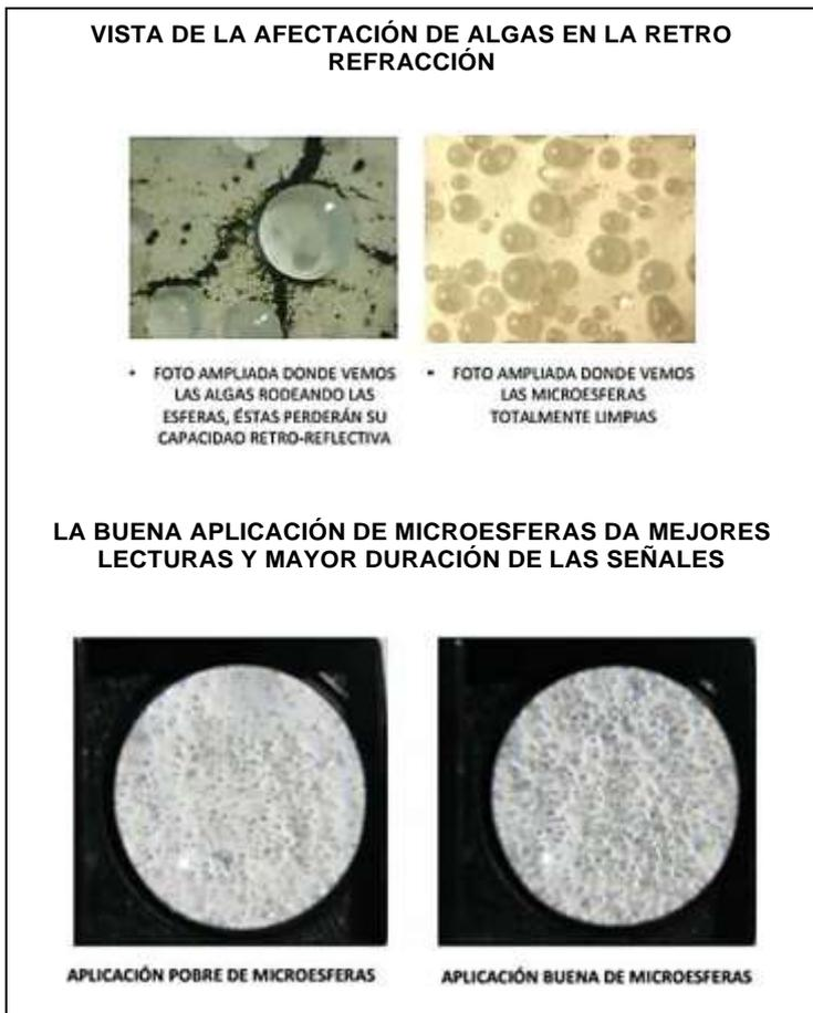
Figura C-7 Diferencia en la aplicación de las microesferas
