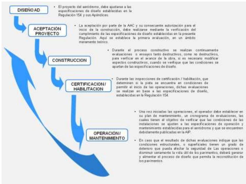
Figura 1-1. Diagrama de vida de un pavimento
