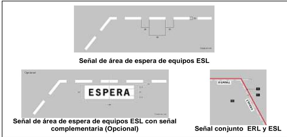
Figura 5-3-11. Señal de área de espera de equipos ESL
