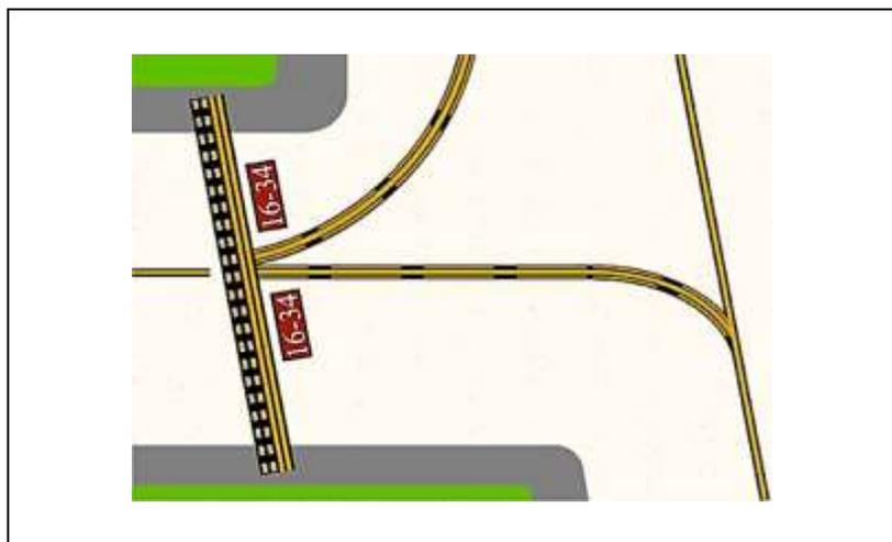
Figura 5-4-12. Dos calles de rodaje convergen a un Punto de Espera en Pista.
