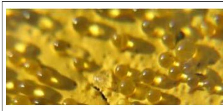
Figura C-16 Poco embebido de las microesferas de vidrio
