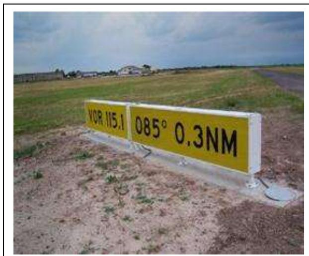
Figura 2-4-2. Letrero de punto de verificación del VOR en el aeródromo
