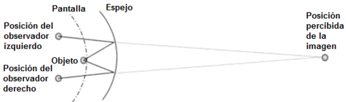
Figura 3.2J Visualización de la pista en una pantalla colimada
