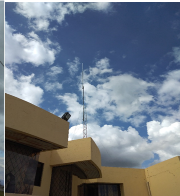
ANTENA OMNI DIRECCIONAL DE 9dBi cobertura NORTE, SUR, ORIENTE, OCCIDENTE (ORETA, TEMOX) TMA-APP-UIO
