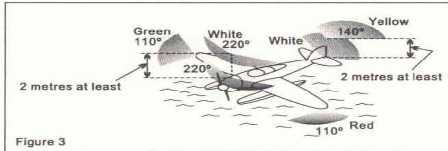
3. Cuando remolque otra nave o avión como se ilustra en la Figura 3, las siguientes luces aparecen como luces fijas sin obstrucción:
