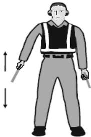
**12. Disminuya la velocidad del motor o los motores del lado que se indica**
