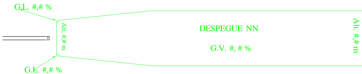
Figura 6-12 - Superficie de Despegue
