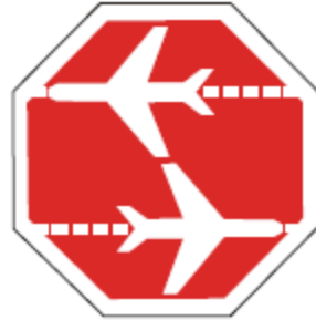
Figura 4-1-2 Señal de detención alternativa para puntos de espera de una vía de vehículos que interseca una calle de rodaje.
